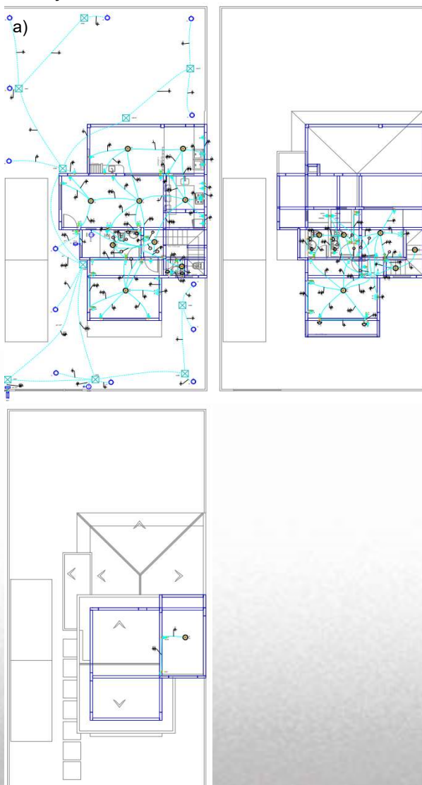
Figura 11 – Instalações elétricas. a) Planta baixa da instalação elétrica. b) Perspectiva de lançamento da instalação elétrica
