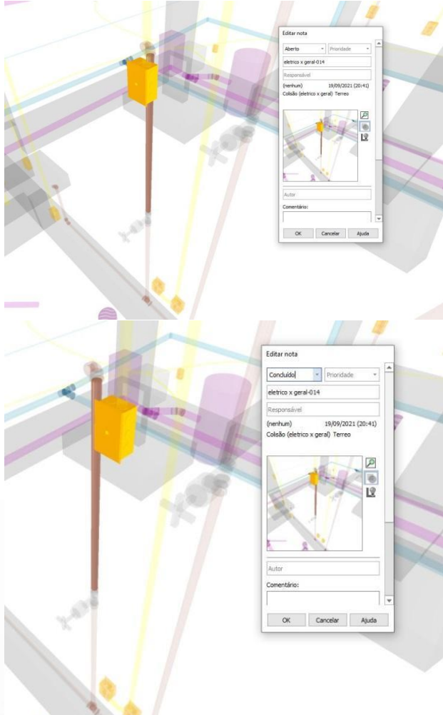
Figura 14 – Incompatibilidade detectada ajustada Elétrico x Hidrossanitário
